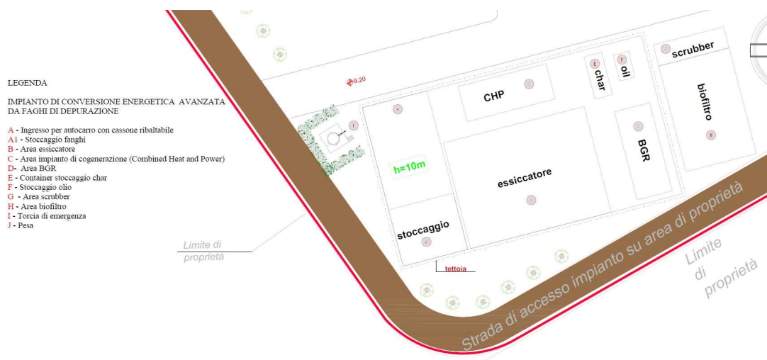
Figura 6 Planimetria della nuova sezione fanghi presso l'impianto di depurazione Basso Tenna CIIP spa
